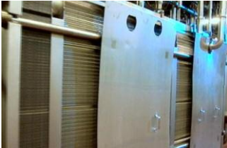
Im Erhitzer wird die Milch bei 72°C pasteurisiert – und damit haltbar gemacht
